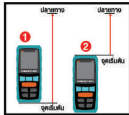
1 การวัดระยะจากท้ายเครื่อง 2 การวัดระยะจากหน้าเครื่อง
