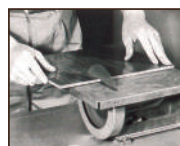
ตัดชิ้นงานแผ่น
